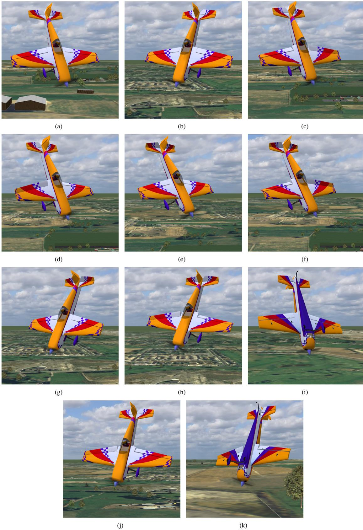
Figure 5. Renderings of the spins using graphics from FS One: a) T0R1E1A0-Lft-Up, b) T0R1E1A0-Rght-Up, c) T0R1E1A1-Lft-Up, d) T0R1E1A1-Lft-Up(cross ail), e) T0R2E2A0-Lft-Up, f) T0R2E2A2-Lft-Up, g) T0R2E2A0-Rght-Up, h) T0R2E2A2-Rght-Up, i) T0R1E1A0-Lft-Inv, j) T0R1E1A1-Rght-Up, k) T0R1E1A1-Rght-Inv.
